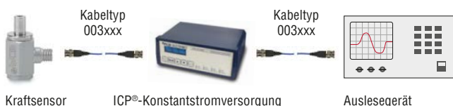
Aufbau einer typischen ICP®-/IEPE-Messkette
