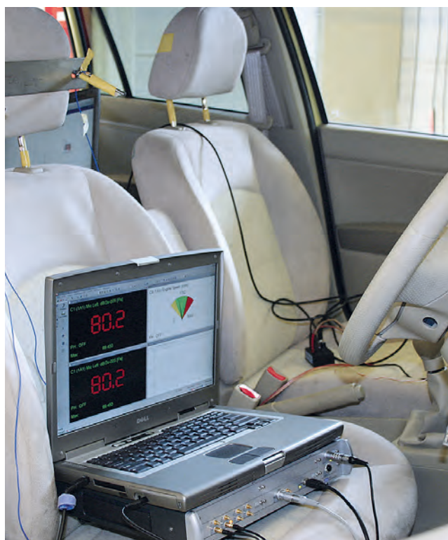
Messung der Geräusche im Innenraum
